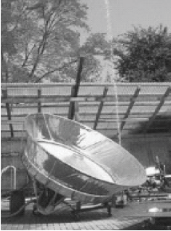
Şekil 23. Güneş enerjisi ile çalışan pompa (Ökotec, 2005)
